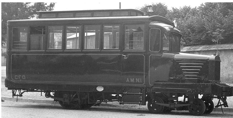
FIGURE 18.3 – Autorail KA à Pontarlier en juillet 1932, après pose du moteur Panhard Diesel et modification de la carrosserie (cliché Stainacre †).
