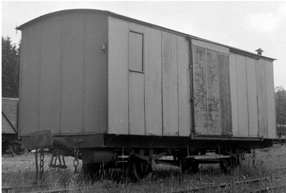
FIGURE 26.4 – Le fourgon-poste C 4 La Buire à Andelot en 1954, après transformation par la compagnie de C.F.D. L'empattement avait été allongé, et la caisse intégralement refaite (cliché A. Artur).
