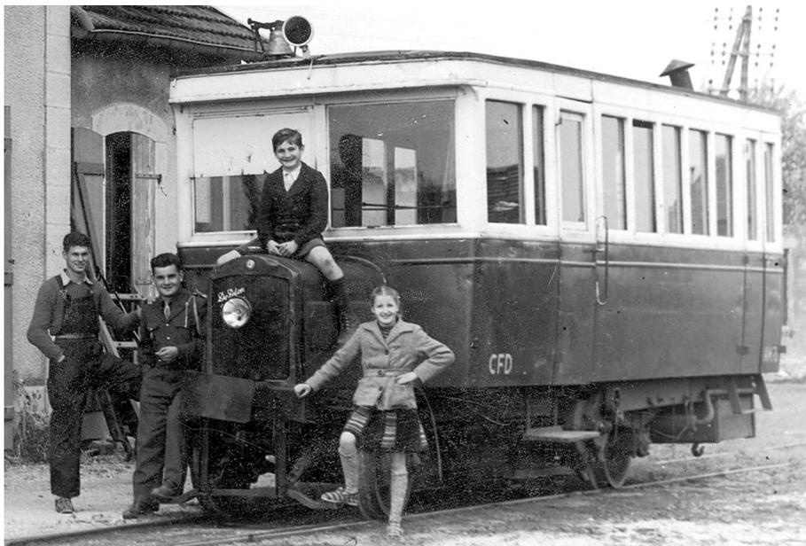
FIGURE 20.7 – Autorail AM 76 à Levier en 1953, c'était le seul à ne pas arborer la mention « AUTORAIL » sur la face avant, en raison du manque de place. On pouvait repérer sur la droite la cheminée du poêle à charbon (cliché Boilloz †, collection Lornet).
