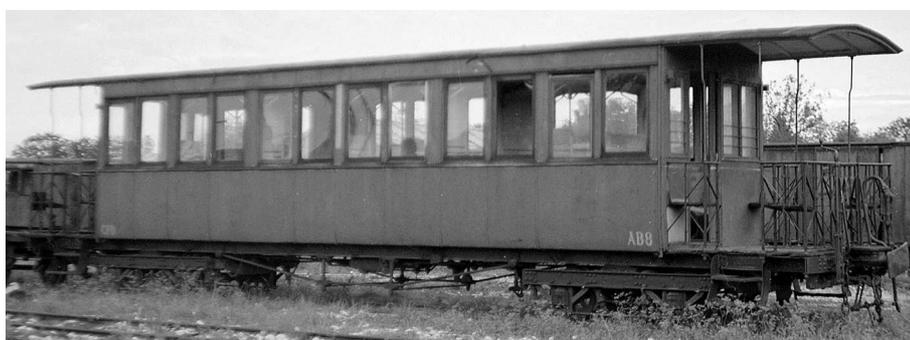
FIGURE 28.2 – Voiture de 2<sup>e</sup> classe à bogies A.N.F. AB 8 à Pontarlier en août 1950 (cliché P. Laurent †).
