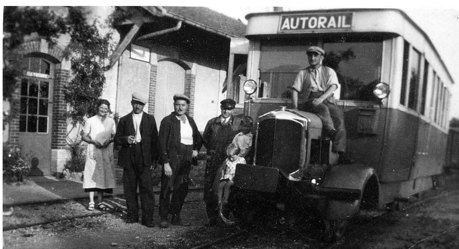
FIGURE 20.2 – Autorail vu à Busy-Larnod au milieu des années 1930. Langutt avait déjà effectué la pose des nouveaux freins, ainsi que des gardes-boues à allure automobile, et un capot moteur modifié. La mention AUTORAIL était apparue, et une boîte aux lettres permettait de récupérer le courrier en cours de route (collection Musée du Tacot).
