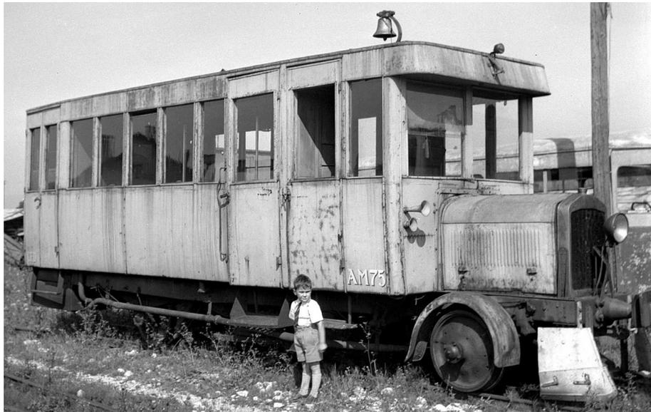
FIGURE 20.5 – AM 75 abandonné à Pontarlier en 1952. Par rapport au modèle du Doubs, on pouvait remarquer la calandre plate du radiateur, ainsi qu'une fenêtre supplémentaire pour le compartiment des voyageurs (Cliché W. Boegli †, collection J.L. Rochaix).
