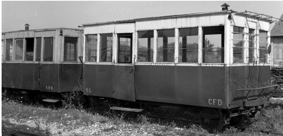
FIGURE 20.9 – Remorque R 6 abandonnée à Pontarlier en 1952. On remarquait aisément l'unique compartiment des voyageurs, avec sa porte d'accès décalée, les crochets pour accrocher les vélos, et la cheminée du poêle à charbon (cliché W. Boegli †, collection J.L. Rochaix).
